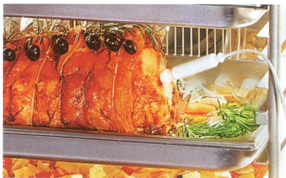
Core temperature probe Maghőmérő
